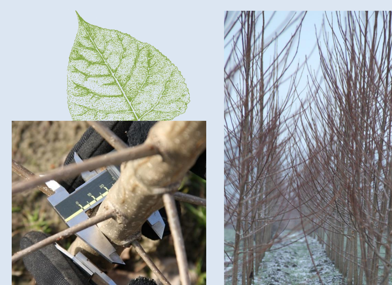
FIG 8 Diametermetingen in wintertoestand (rechts) met digitale schuifpasser (links) op 22 cm boven het grondoppervlak.
