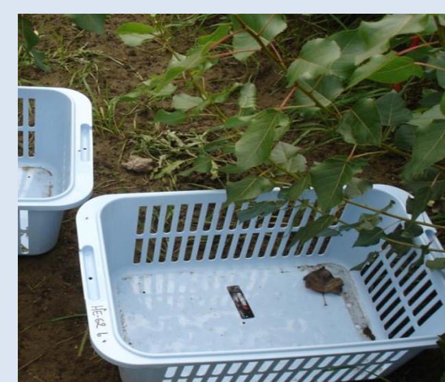
FIG 3 Indirecte LAI-bepaling a.h.v. LAI-2000 (rechts) en directe bepaling via opvang van bladval in manden (boven). Significante correlatie tussen beide methodes (rechtsboven).
