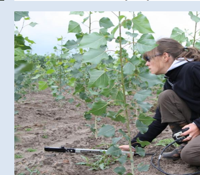
FIG 3 Indirecte LAI-bepaling a.h.v. LAI-2000 (rechts) en directe bepaling via opvang van bladval in manden (boven). Significante correlatie tussen beide methodes (rechtsboven).
