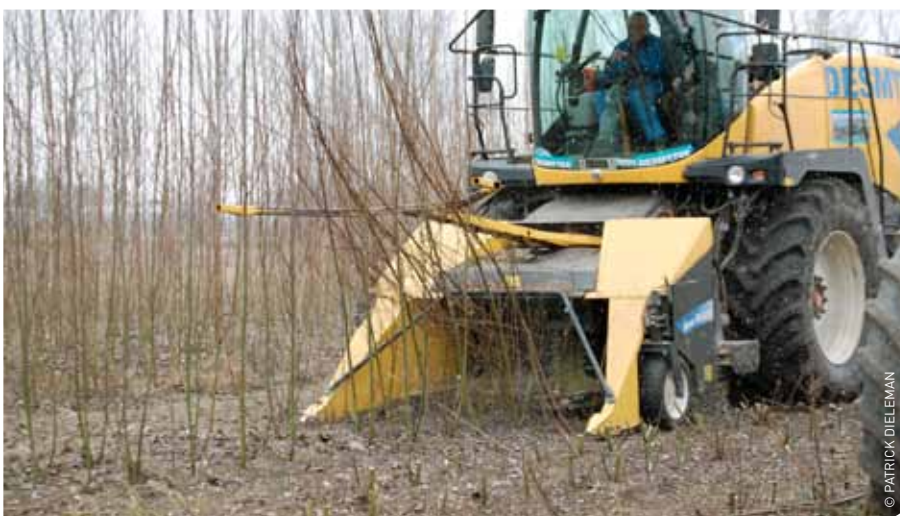
Een gewone hakselaar van New Holland wordt een oogstmachine voor korteomloophout met behulp van een vork om de bomen om te duwen en een voorzetstuk waarmee de twijgen afgezaagd en verkleind worden.
